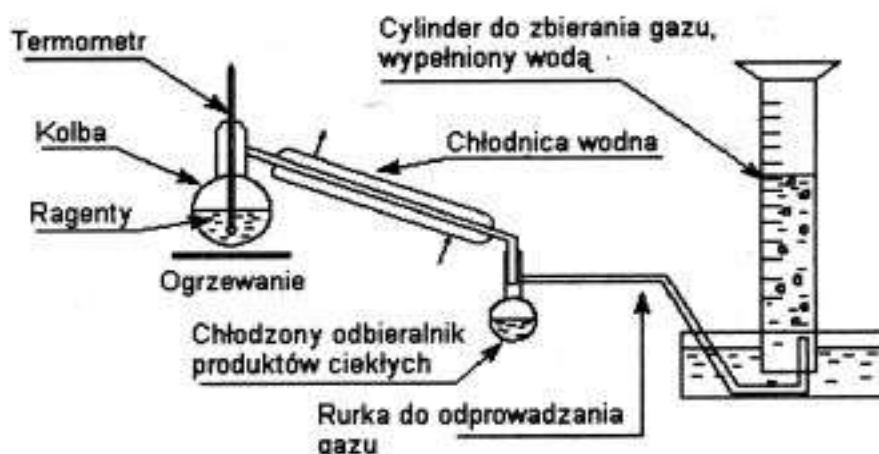
Aparatura do przeprowadzenia reakcji etanolu z kwasem siarkowym(VI)
